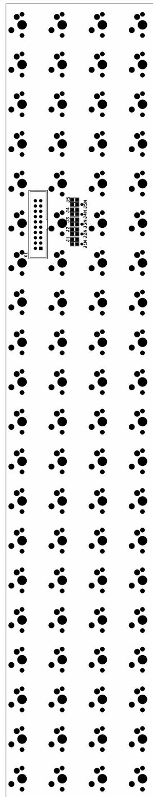
Примечание 1. Механические клавиши не входят в комплектацию платы, поскольку сначала они устанавливаются в металлическую решетку SMF8106.00.013, и только затем на их контакты устанавливается плата, после чего осуществляется пайка.
