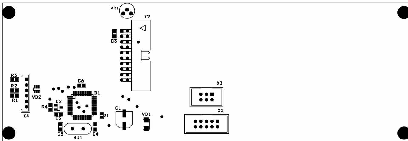
Примечание 1. Для использования совместно с платой SME807.34.000СБ (индикатор VFD) перемычка J1 должна быть запаяна. Для использования с LCD-индикатором BFC22201ULGW перемычка должна быть разомкнута.
