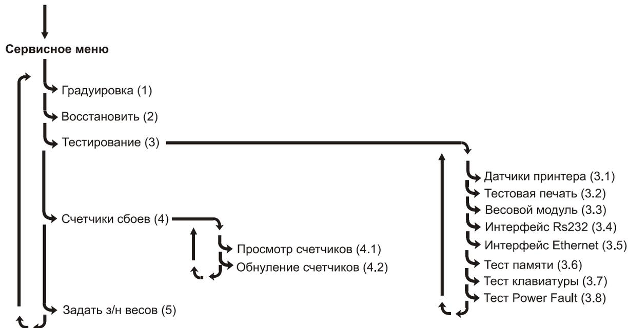
Вход в сервисное меню возможен двумя способами: из рабочего режима весов и в случае, когда возникла ошибка в процессе самодиагностики весов.
