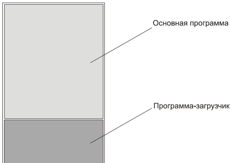
Программа-загрузчик прошивается в микроконтроллер на заводе-изготовителе и защищается с помощью lock-битов от чтения и записи через разъем программирования (разъем X11 - см.Рисунок 26). Программа-загрузчик необходима, чтобы работать с основным ПО, например обновлять версию основного ПО. При включении устройства сначала всегда запускается программа-загрузчик.
